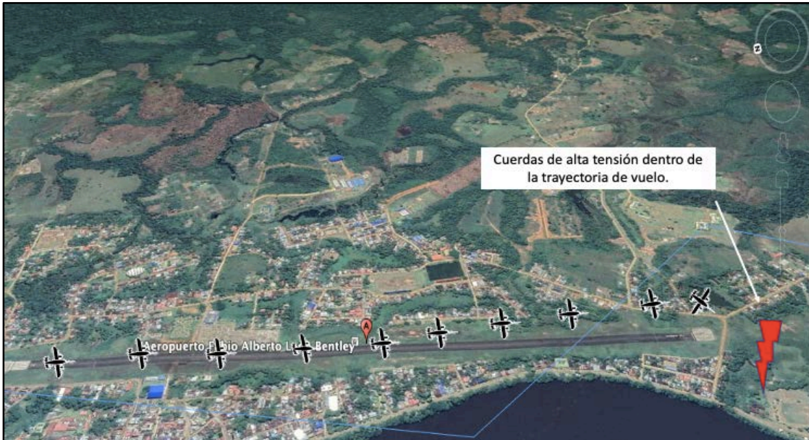
Imagen No. 4 - Cuerdas de alta tensión, en la trayectoria del viraje.
