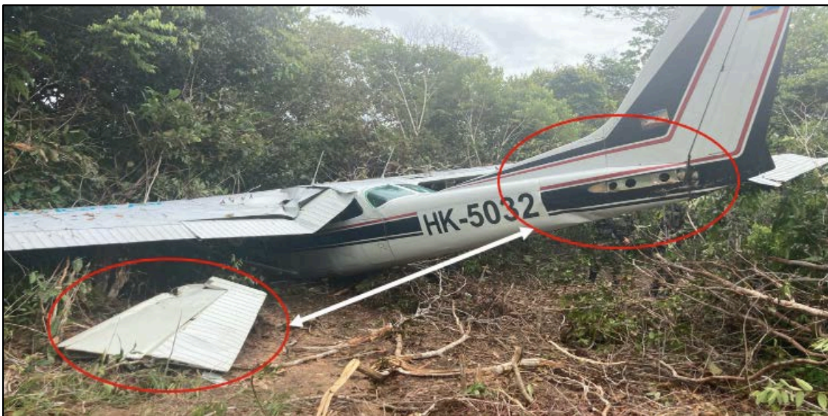
Fotografía No. 5 - Daños estructurales e la zona 300, estabilizador vertical.
