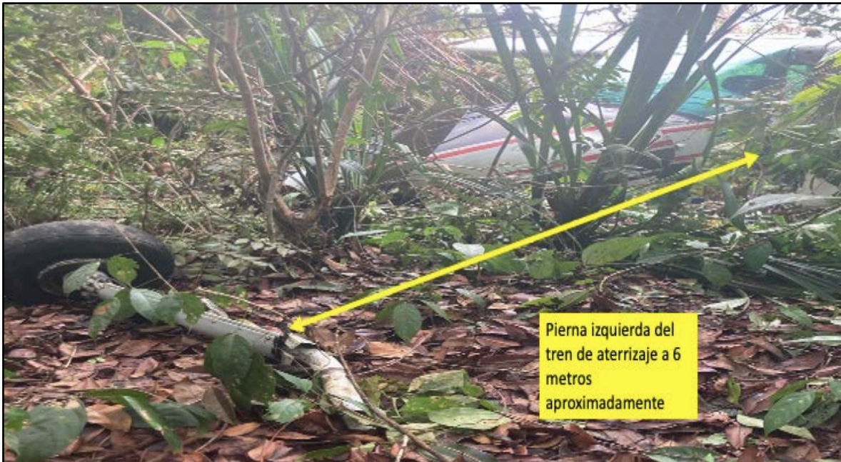
Fotografía No. 6 - Daños estructurales e la zona 700, tren de aterrizaje izquierdo.
