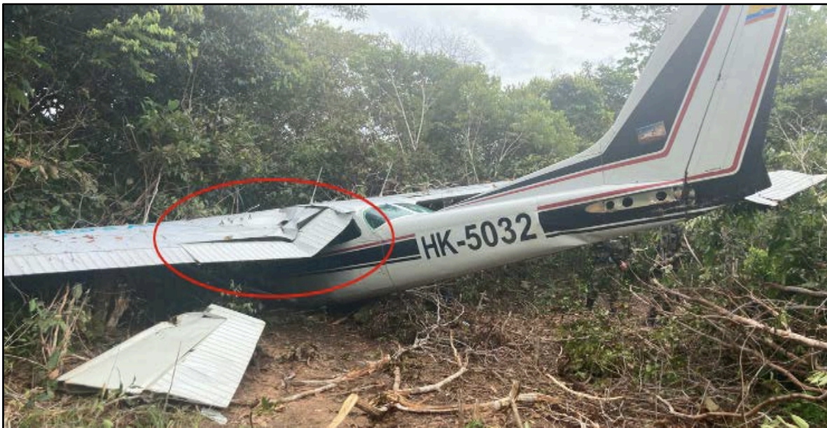
Fotografía No. 4 - Daños estructurales e la zona 500, plano izquierdo.
